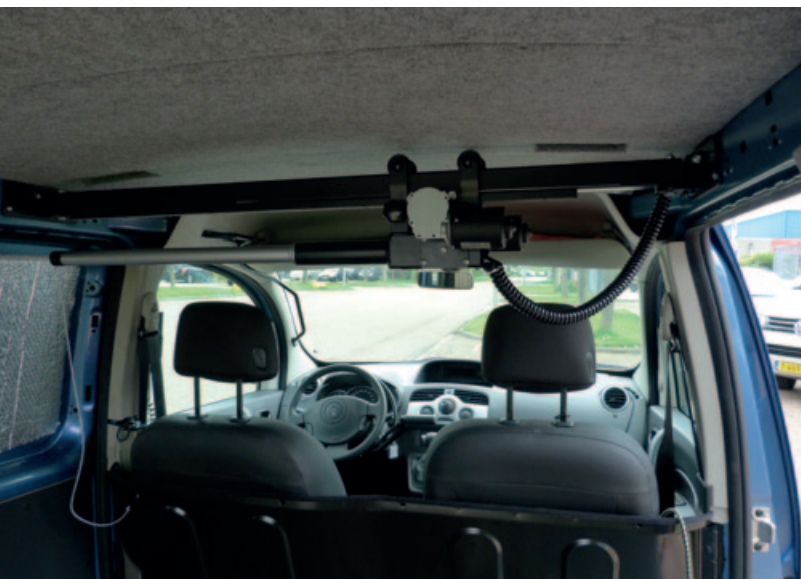
De DC-aandrijving van deze rolstoellift in een auto is een goed voorbeeld van een klantspecifieke oplossing
